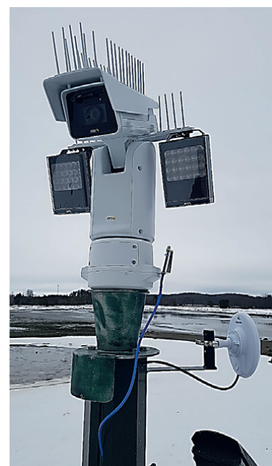
Webkameraet på Ilene er utstyrt med IR-lys, vindusspyler og en antenne for trådløs overføring til våtmarkssenteret.
